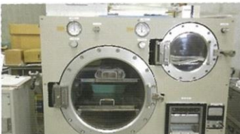
14. 真空凍結乾燥 Vacuum freeze drying
