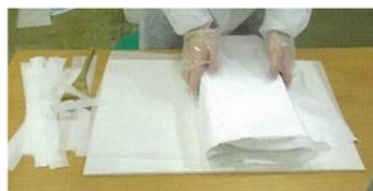
12. 耐油紙および不織布による保護 Protection with oil proof paper and nonwoven fabric
