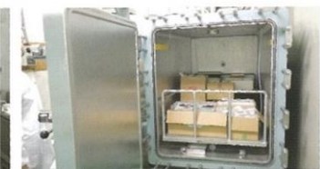
15. 資料消毒(滅菌機によるくん蒸) Document sterilization (fumigation by sterilizer)
