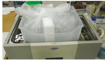
7. 水道水による超音波洗浄 Ultrasonic cleaning using tap water
